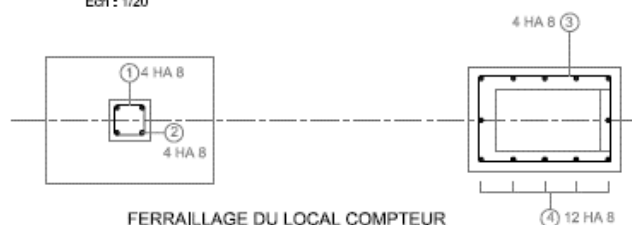
FERRAILLAGE DU LOCAL COMPTEUR
